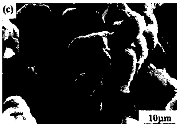
Fig 1.11 127 SEM micrografía He carbón esferoidal
