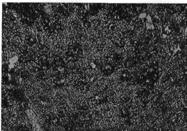
Fig. 3.8.- Picadura; muestra de KHR 45 sin lavar (SEI)
