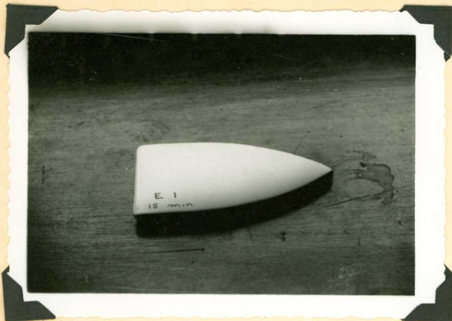
Muestra de E-1 bañada sobre Fierro Gris. Temperatura de quemado 815°C. Tiempo de quemado 15 minutos.
