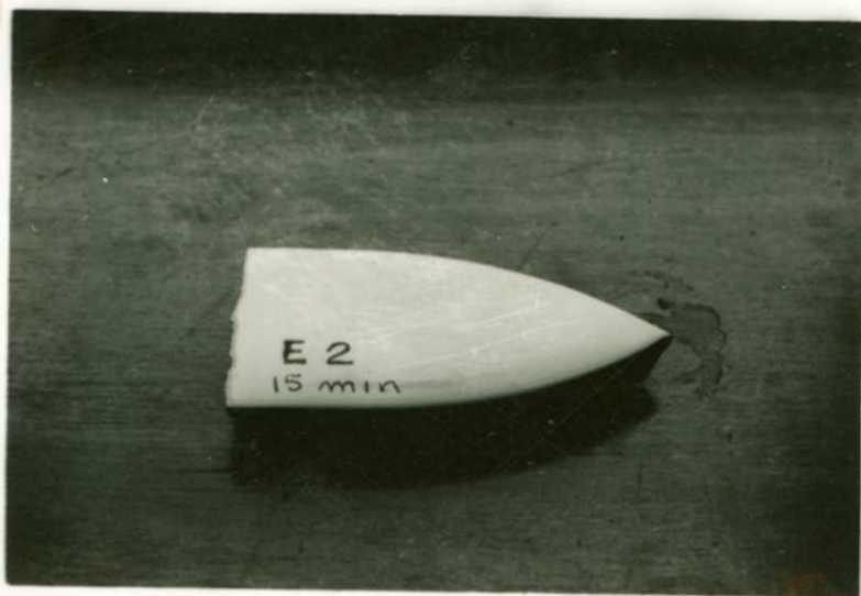
Muestra de E-2 bañado sobre Fierro Gris. Temperatura de quemado 815°C. Tiempo de quemado 15 minutos
