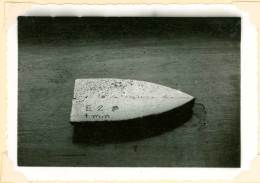
Muestra de E-2 bañada sobre Fierro Gris. Temperatura de quemado 815°C. Tiempo de quemado 7 minutos.
