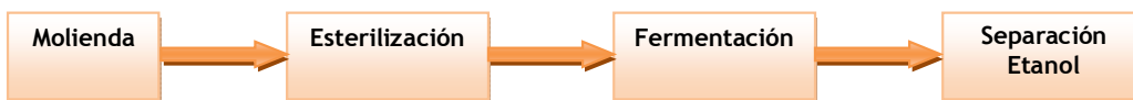
Figura 3.3: Diagrama de bloques para el proceso de obtención de etanol a partir de sorgo dulce
