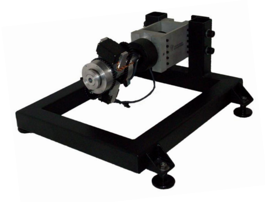
Figura 17 – Fotografía de la estructura y rotor de prueba con el dispositivo de balance ensamblado.
