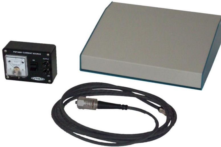
Figura 18 – Fotografía del gabinete de control (superior derecha), acelerómetro (inferior) y fuente de corriente para acelerómetro (superior izquierda).
