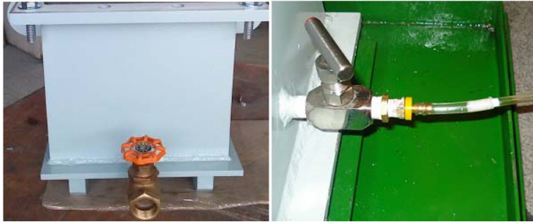
Figura 3.4 Válvula de drene y válvula de muestreo.
