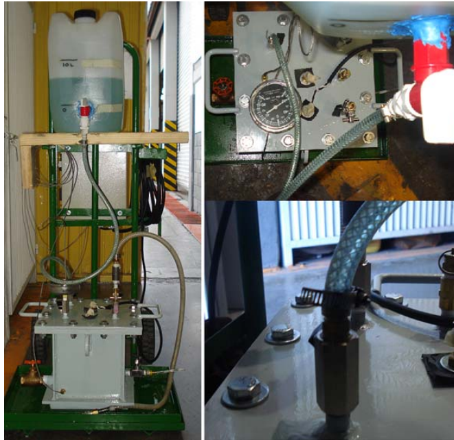
Figura 4.16 Llenado del reactor con aceite dieléctrico.
