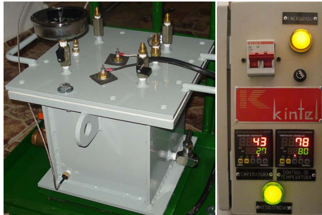
Figura 3.2 Equipo de experimentación. Reactor químico y control de temperatura.
