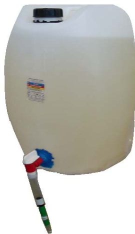
Figura 4.4 Porrón de plástico con adaptador para obtener la muestra de aceite.
