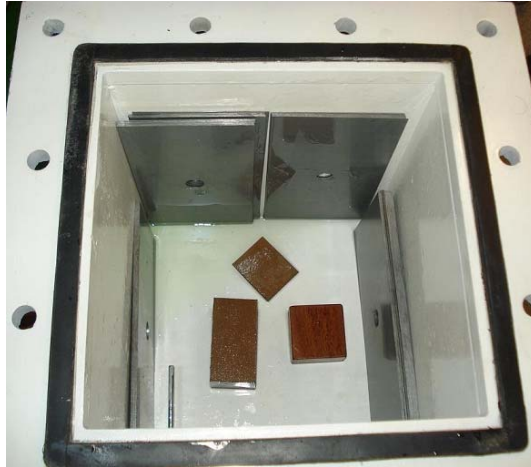
Figura 3.7 Materiales dentro del reactor químico.
