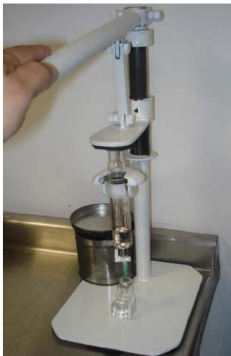
Figura 4.5 Inyección de aceite en viales.
