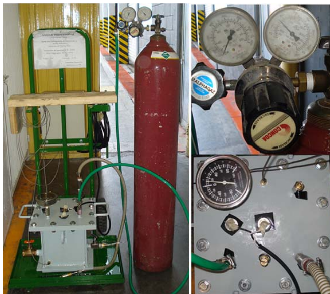
Figura 4.17 Inyección de nitrógeno al reactor químico.
