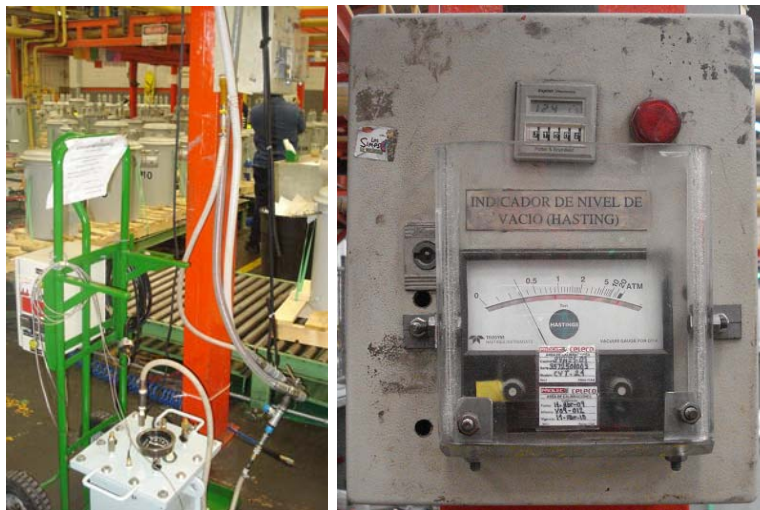
Figura 4.15 Proceso de vacío del reactor químico y hasting utilizado.
