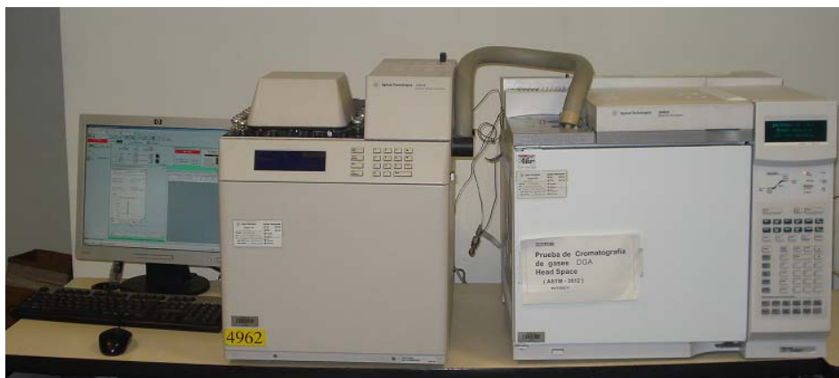
Figura 4.2 Headspace y cromatógrafo de gases utilizados para el experimento.
