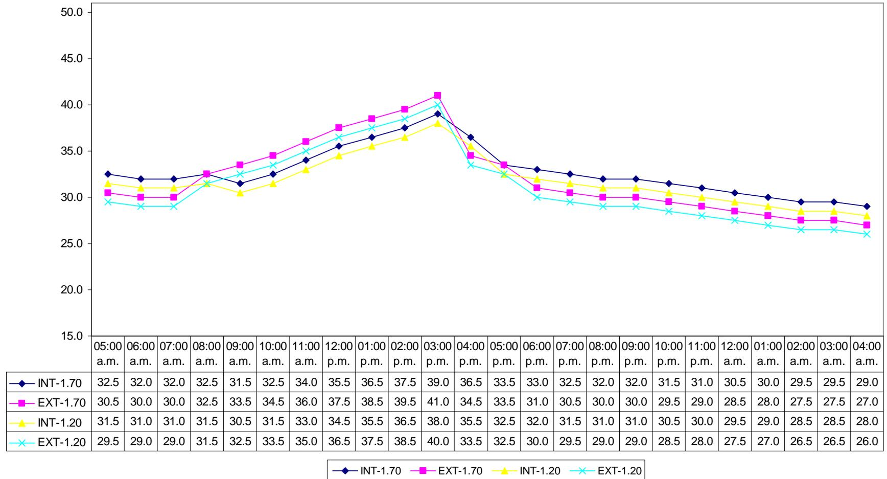
FACHADA OESTE - CASA LOSA A DOS AGUAS - LOSA CON IMPERMEABILIZANTE ASFALTICO
