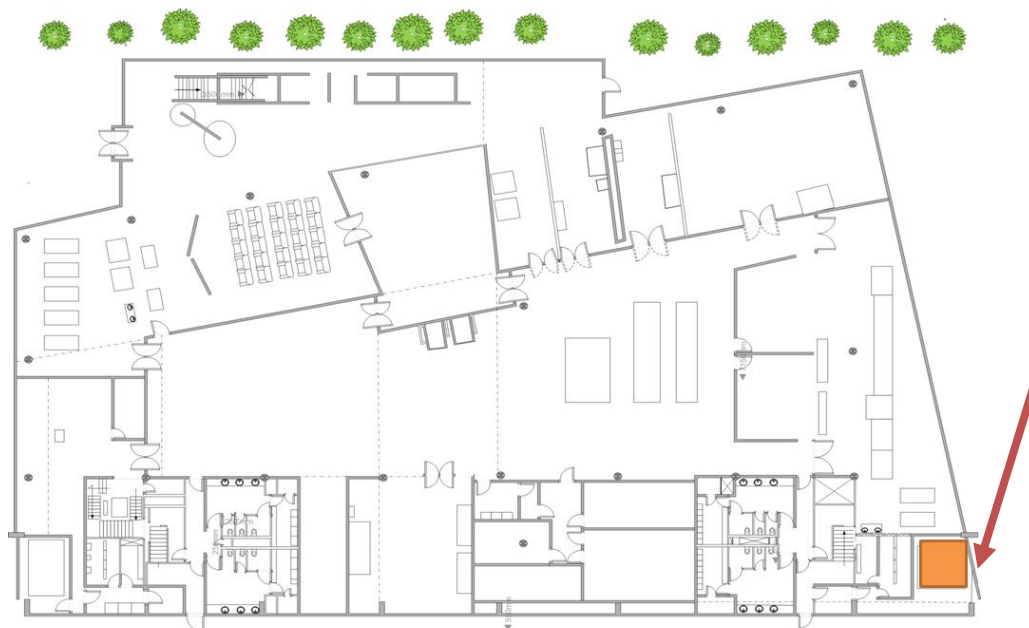
Figura 3.- Ubicación del cuarto de entrada
