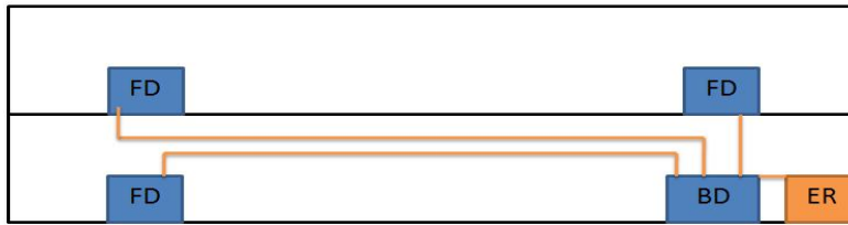
Figura 1.- Arquitectura de Red Distribuida
