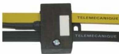
Figura 4.2.- Cable AS-i y Cable auxiliar [http://www.as-interface.net/]
