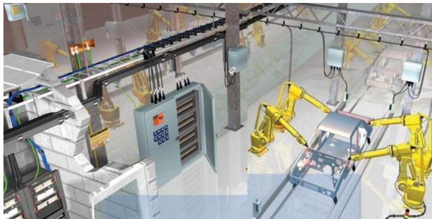
Figura 6.- Cableado de Cuarto de Telecomunicaciones a Gabinete Industrial
