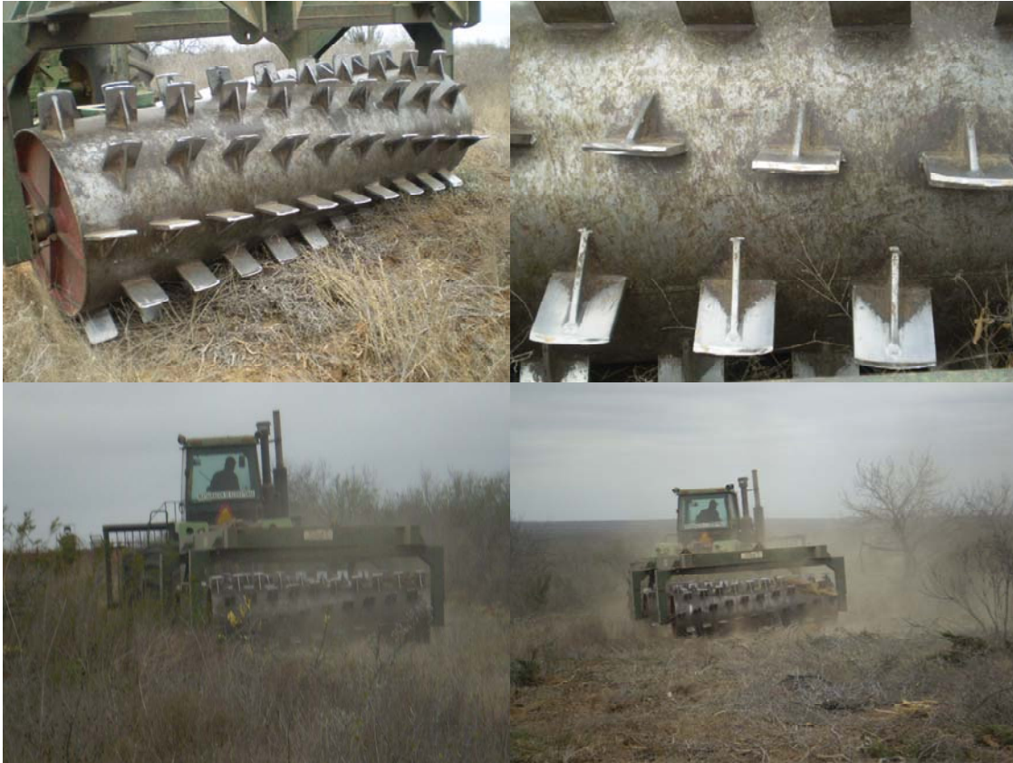
Figura 24. Vista del tipo de rodillo y cuchillas correspondiente al rodillo aireador y procedimiento de paso aplicado para el tratamiento del predio. Demostración experimental en el Rancho Rosita, Anahuac. N. L. Mayo, 2008.
