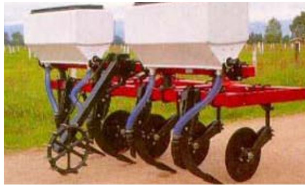
Figura 6. Vista de la maquinaria correspondiente a un renovador de praderas con cinceles. Lozano, 2004
