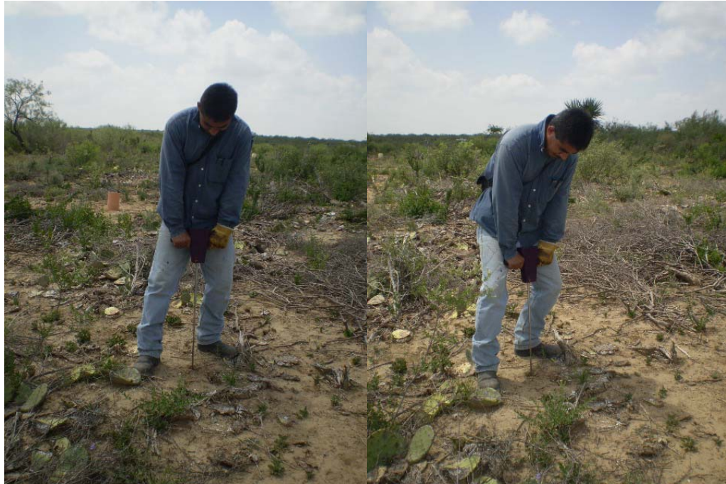
Figura 32. Vista de la medida de resistencia a la penetración en suelo con el penetrómetro.
