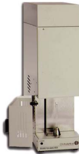
Figura 29. Vista frontal del TOC Analyzer empleado para determinar el contenido de carbono orgánico de las muestras analizadas en este estudio.
