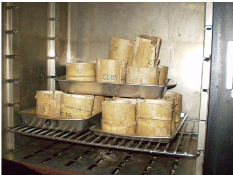
Foto 4.2. Colocación de las muestras en el horno durante 24 horas, a 103 °C
