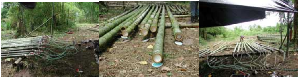
Foto 2.3. Preservación de Guadua angustifolia mediante el método de Boucheri modificado. Estación Experimental Los Diamantes, Guápiles, Costa Rica.
