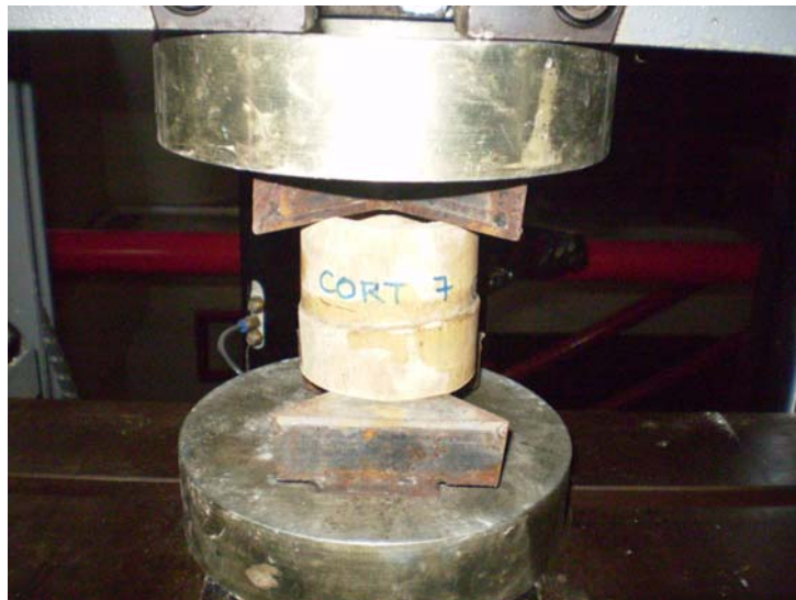
Foto 4.7. Colocación de la muestra para el ensayo a Corte. Prueba realizada en la máquina Universal Laboratorio de Estructuras ITESM.
