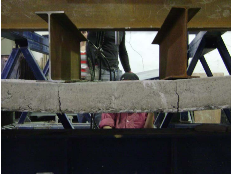
Foto 6.10. Falla por flexión presentada en losas de 3 metros de Longitud.
