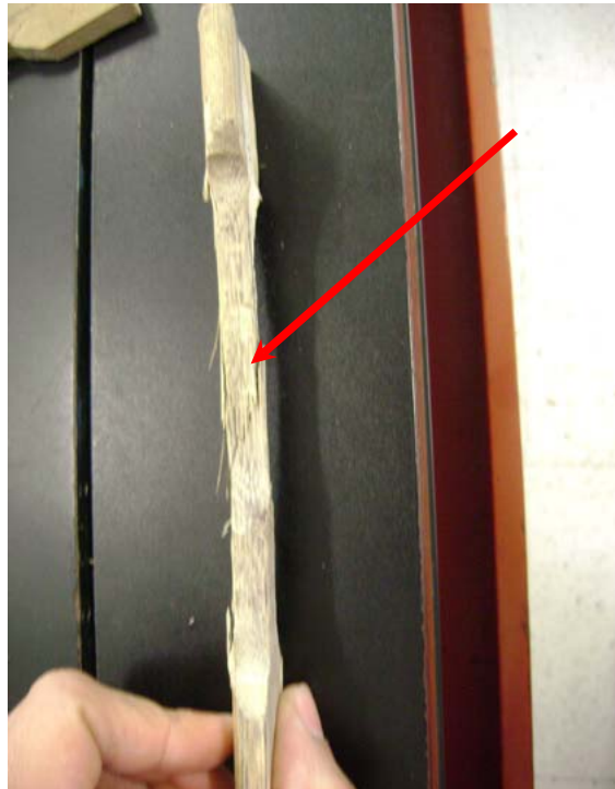
Foto 4.11. Falla a Tensión del bambú.
