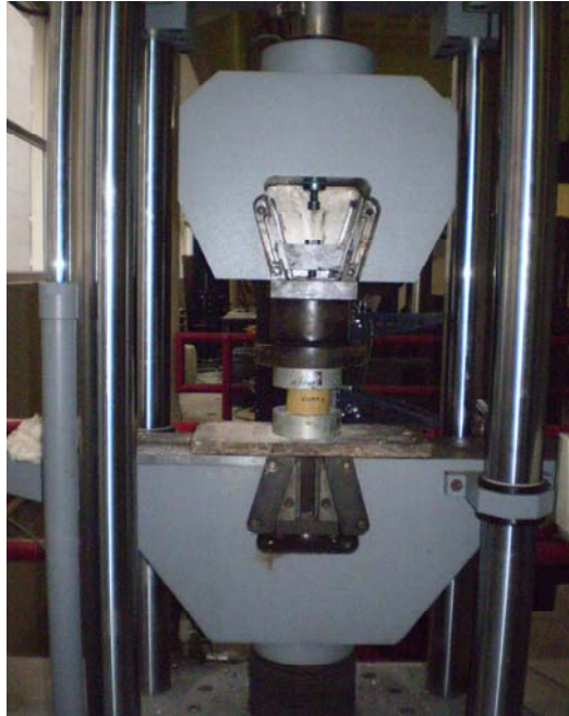
Foto 4.3. Ensayo a Compresión, en la máquina universal.
