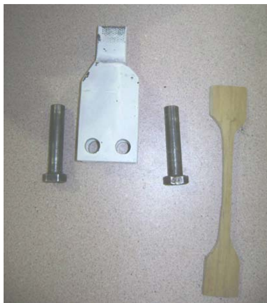
Foto 4.9. Dispositivos de amarre para realizar el ensayo a tensión.
