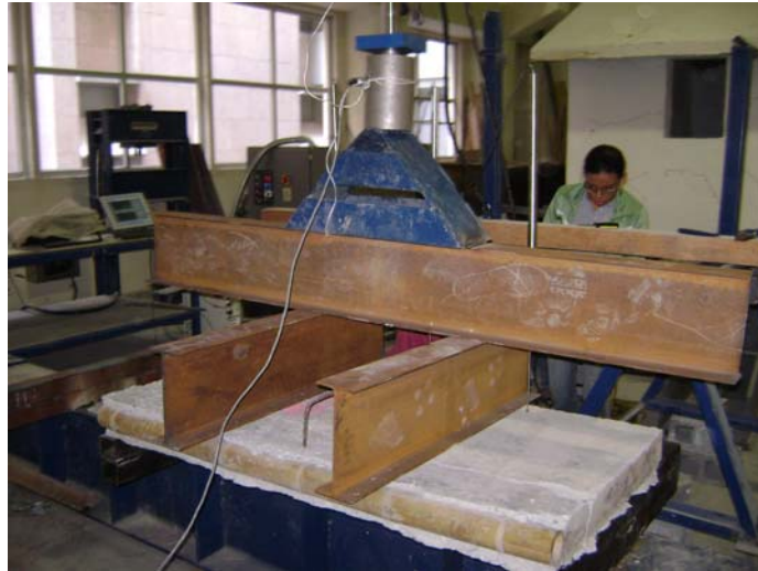
Foto 6.8. Sección incompleta de losa de 10 cm de espesor, ensayada a flexión
