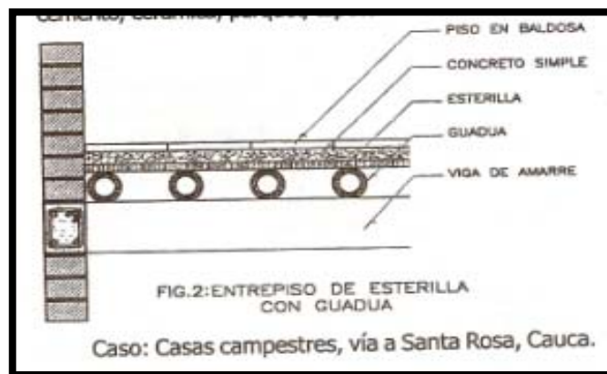
Figura 2.5. Sistema de Entrepiso de Madera
