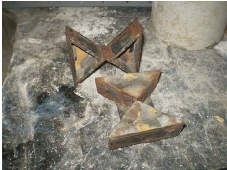
Foto 4.6. Dispositivos utilizados en el ensayo a Corte.
