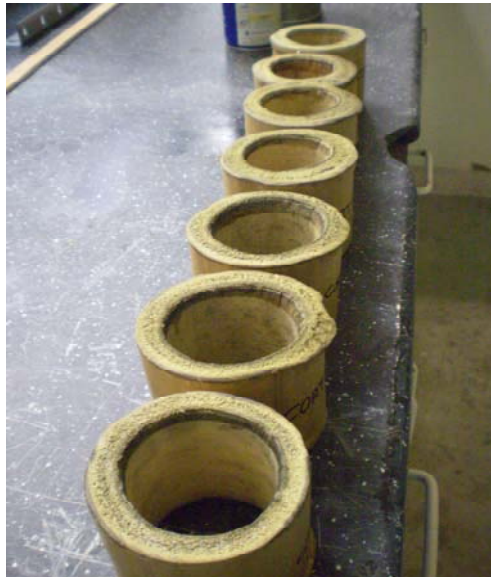
Foto 4.4. Muestras de bambú después del ensayo a compresión
