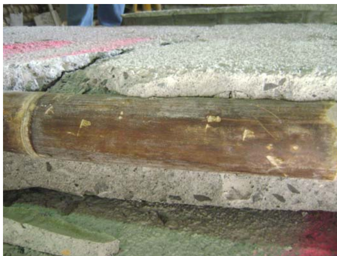
Foto 6.7. Muestra del bambú después de haber realizado el ensayo a flexión..
