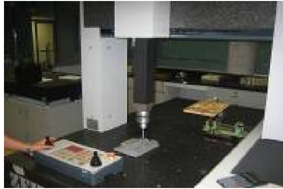
FIGURA 12 Medición de la tapa BCI 42 en máquina de coordenadas
