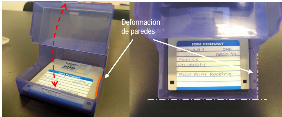
FIGURA 2 Problema de funcionalidad debido a deformación del producto, contenedor para discos
