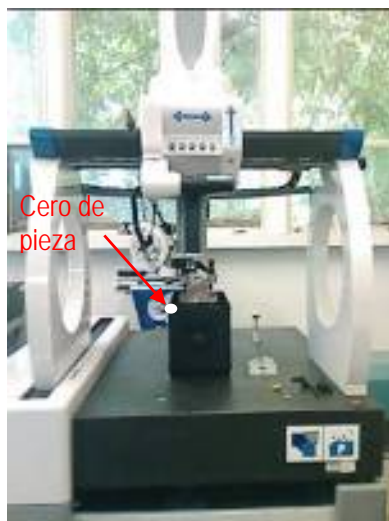
FIGURA 68 Mediciones de la caja MC30H en máquina de coordenadas.
