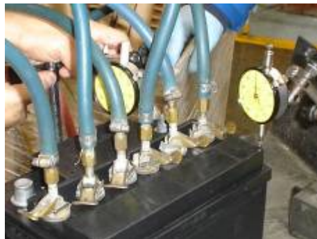
FIGURA 24 Arreglo para medir deformaciones, Batería ensamblada BCI 42
