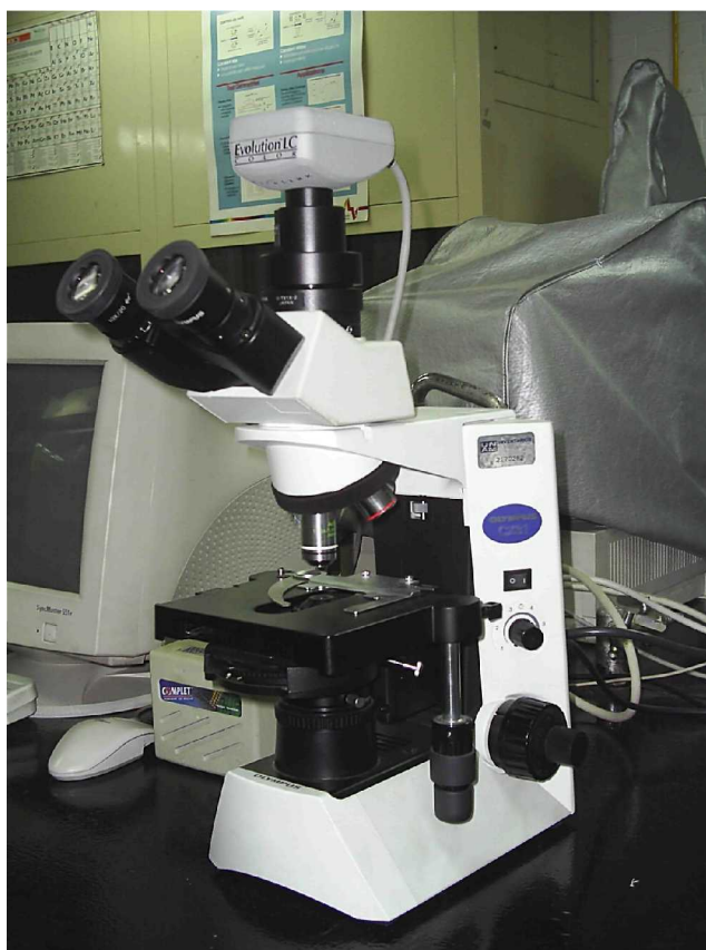
Figura 4.6 Microscopio óptico equipado con cámara fotográfica para la medición de los glóbulos de grasa en leche.
