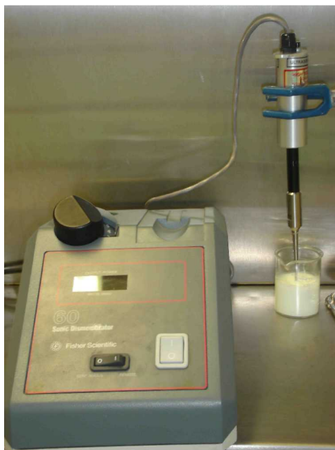
Figura 4.4 Equipo emisor de ultrasonido (60 Sonic Dismembrator) con sonotrodo sumergido en una muestra de 60 mL de leche.
