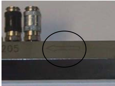
Figura 2.49 Marca del sentido de flujo del aire comprimido Referencia. Información Interna de Festo
