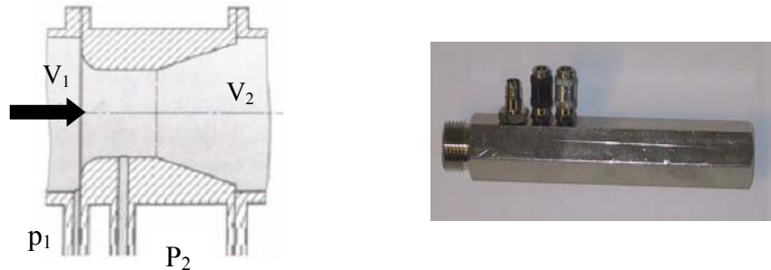
Figura 2.52 Sensor de caudal alto por diferencia de presión en el equipo VSM3K Referencia. Información Interna de Festo
