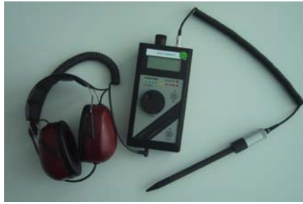
Figura 2.53 Sensor de ultrasonido para detectar fugas en lugares silenciosos Referencia. Información Interna de Festo
