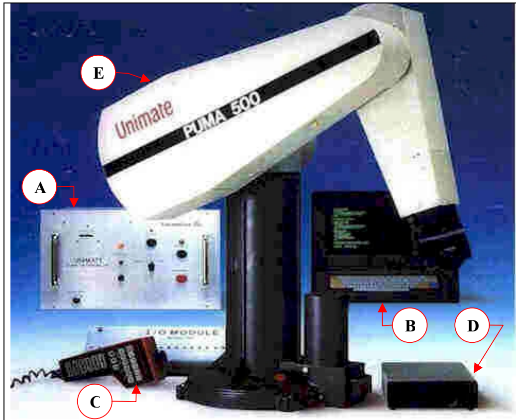
Figura 2.12 Componentes principales del sistema robótico PUMA 560
