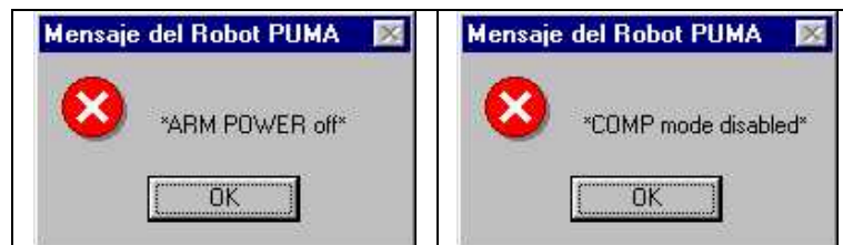
Figura 4.7 Mensajes de error desplegados por el controlador del robot. A la izquierda un mensaje notificando al usuario que el brazo no tiene energía. A la derecha notificando que la terminal no ha sido habilitada para control del robot.
