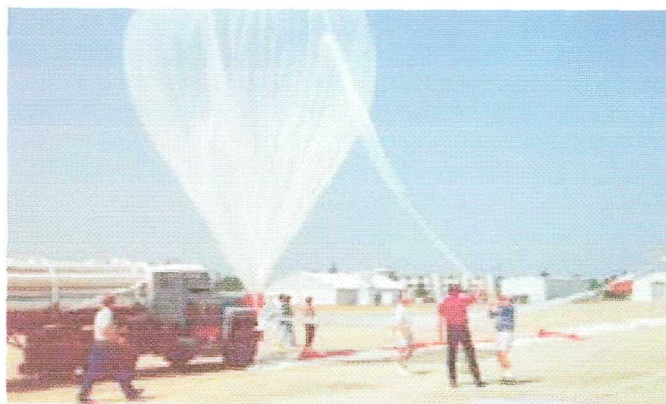
Figura A.21. Globos sonda construidos de polietileno.
