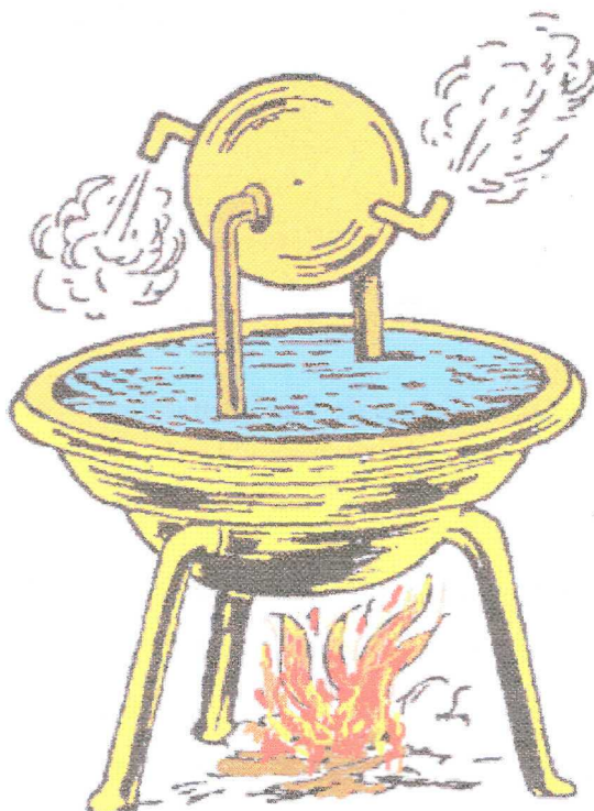
Figura A.1. Aelopile inventado por Hero de Alejandría.
