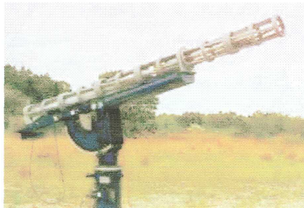
Figura A.26. Lanzador y cohete Super Loki.
