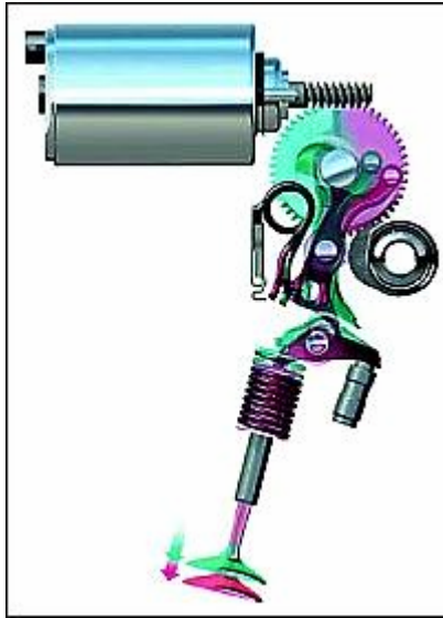
Figura 1. 24 Incremento de apertura gracias al valvetronic. Imagen modificada de www.transporte.cu
