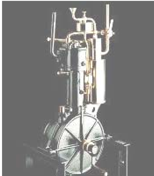
Figura 1. 2 1886 Motor de un pistón de Daimler de 1.1 HP. [1]
