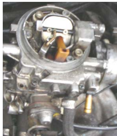
Figura 3. 10 Carburador de un automóvil. Imagen tomada de http://mrpetah.homelinux.org/img/ibiza/carburador
