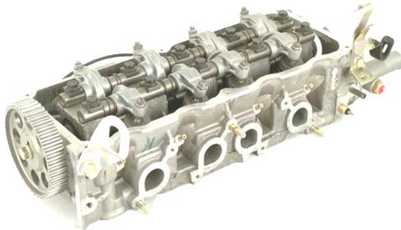
Figura 3. 5 Cabezal de un motor de 4 cilindros con doble árbol de levas. Imagen modificada de www.cobbtuning.com
