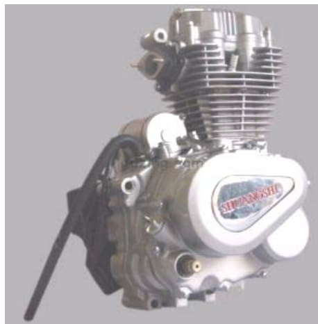
Figura 3. 3 Bloque de motor enfriado por aire. Imagen modificada de www.motoboard.com
