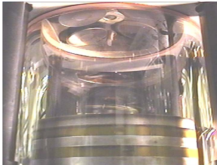
Figura 3. 12 Cámara de combustión visible. Imagen modificada de [24]
