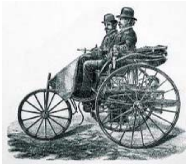
Figura 1. 4 1886 Automóvil de tres ruedas patentado por Benz [1]
