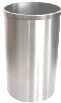
Figura 3. 18 Camisa que hace la función de cilindro del motor. Imagen modificada de [28]
