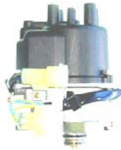
Figura 3. 37 Distribuidor eléctrico completo. Imagen tomada de [31]
