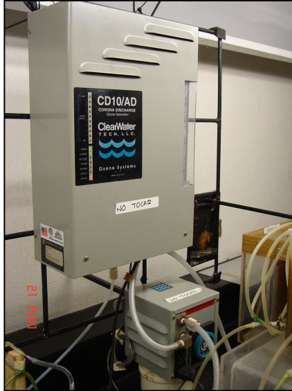
Figura 3.3 Generador de ozono modelo Clear Water CD10/AD
