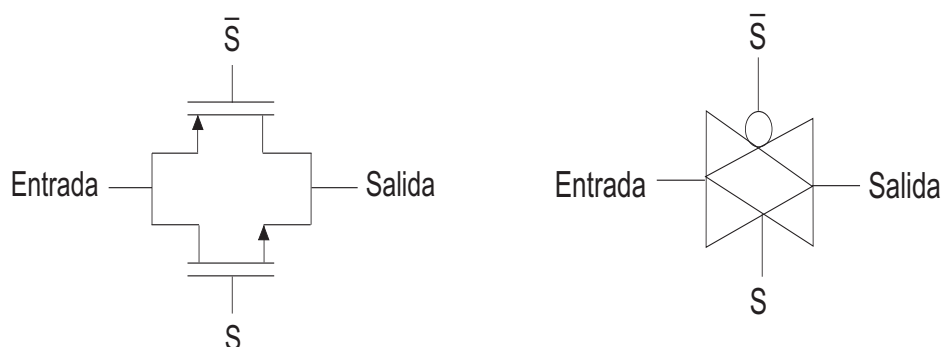
Figura 2.3: Diagrama circuital y símbolo lógico de un “transmission gate”.
