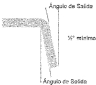
Figura 5.16 Esquema de ángulo de salida 5 .
