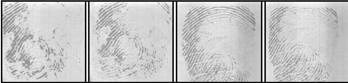
FIGURA 2.11: Un ejemplo de una mala interacción con el sensor, en la figura obtenida de [26] se muestran cuatro impresiones de la huella digital de un individuo que no tenía mucha tinta en el dedo para plasmar las grietas principales de su huella digital.
