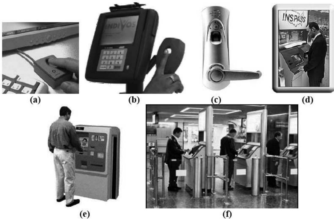
FIGURA 2.9: Ejemplos de aplicaciones biométricas presentados por [26]: a) Sistema de verificación de huellas digitales desarrollado por Digital Persona, es usado para el acceso a computadoras y redes. b) Puntos de venta basados en verificación de huellas digitales desarrollado por Indivos, se emplea para el pago en tiendas, restaurantes y cafeterías. c) Cerraduras basadas en verificación de huellas digitales desarrollado por BioThentica Corporation, usado en accesos restringidos. d) Sistema acelerado del Servicio de Inmigración y Naturalización (INSPASS), instalado en los aeropuertos de Estados Unidos basado en la verificación de la geometría de la mano y desarrollado por Recognition System. e) El sistema FacePass de Viisage es usado para la verificación en puntos de venta. f) Aeropuerto Ben Gurion en Tel Aviv emplean la geometría de la mano para sistemas de seguridad e inmigración.
