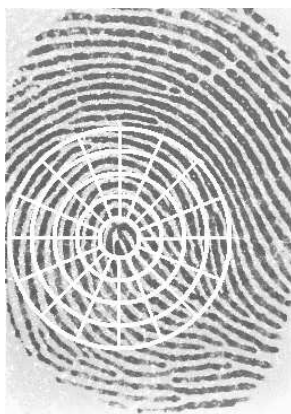
Figura 4.1: Area de interés dividida en 64 sectores
