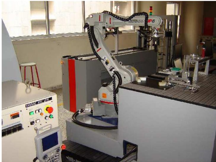
Figura 5.1: Brazo manipulador robótico Motoman UP6.
