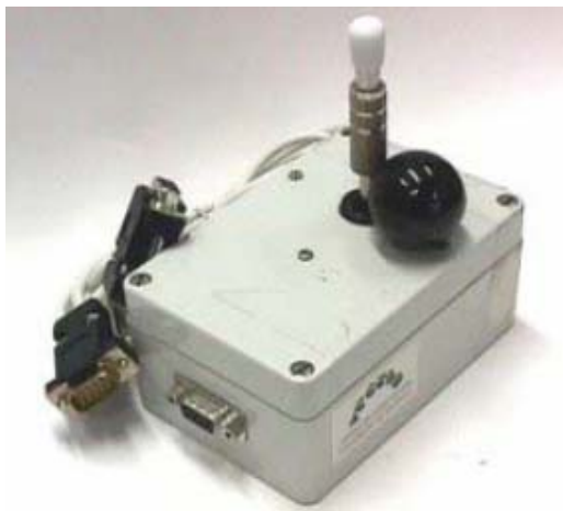
Figura 4.6 Emulador de ratón por joystick (Fuente: Alcantud, n.d.)
