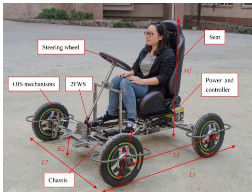
Figura 2.1: prototipo de vehículo eléctrico con dirección Steer by wire en las 4 ruedas. Nota: tomado de Zhang et al. (2017) [13]. (Original en colores)
