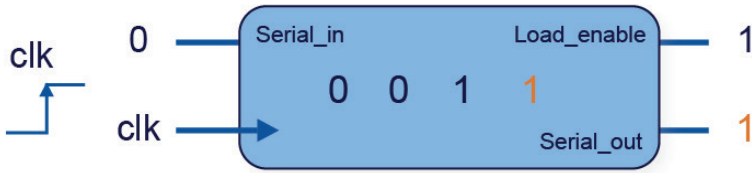
Figura 6.10 Funcionamiento registro serial
