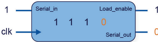
Figura 6.8 Funcionamiento registro serial
