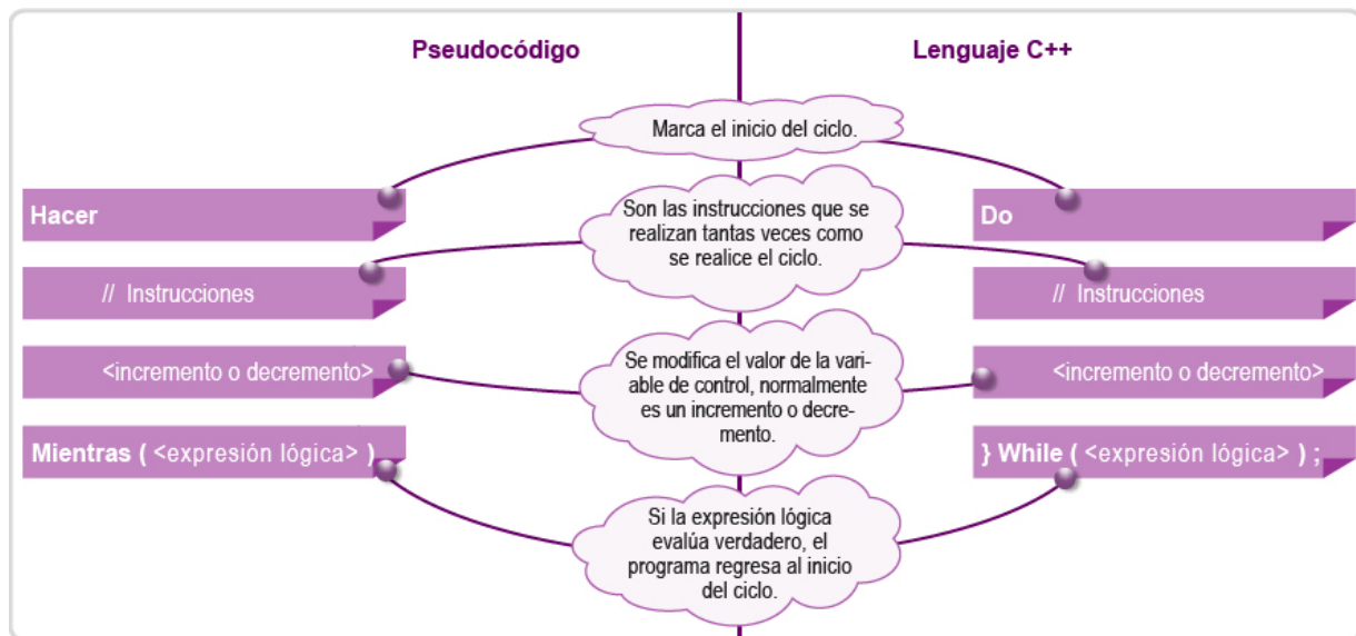
Figura 4. 20. Sintaxis de la estructura do-while.
