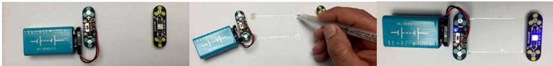
Figura 4.4. Kit Circuitscribe, proceso de conexión de un circuito. Imagen propia del autor (R.A.Z.)
