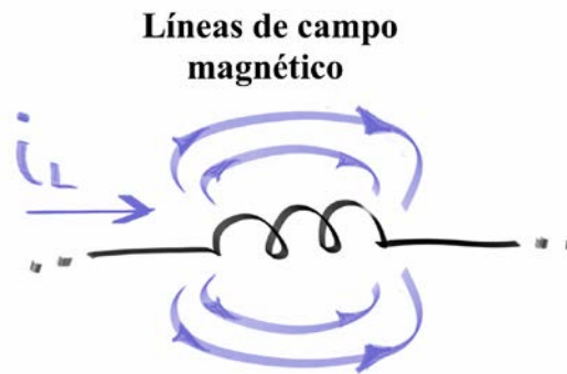
Figura 3.2.8. Líneas de campo magnético en un inductor al pasar corriente eléctrica. Imagen propia del autor (R.A.Z)
