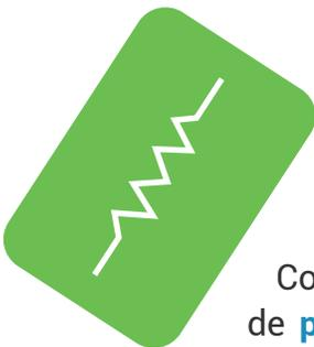
Por otra parte, se puede afirmar que la **carga** que se representa con esta **señal**, corresponde a una **resistencia**, porque como ya sabes, en una resistencia el voltaje y la corriente siempre están en **fase**.
