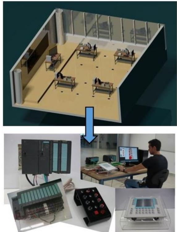
**Figura 5:** Distribución de las estaciones de automatización y equipamiento considerado por estación.
