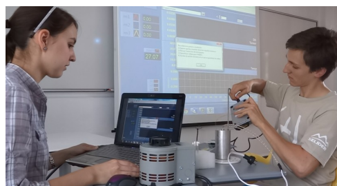
Figura 8. Fotografía de un instrumento de DTA contruido y usado por los alumnos
