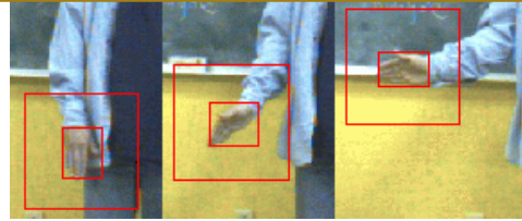
Figura 3: Secuencia de 3 imágenes del seguimiento de la mano. El cuadrado que rodea la mano segmentada corresponde a la ventana de búsqueda de 120 \times 120 píxeles cuya posición se actualiza de acuerdo al movimiento de la mano.
