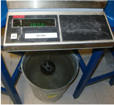
Figura. 3.2 Obtención de Peso de probetas sumergidas.
