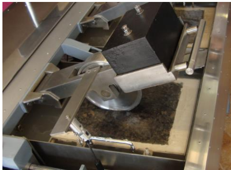
Figura. 3.4 Probetas sumergidas a la Rueda Cargada de Hamburgo.
