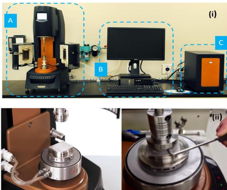
Figura 4.3. (i) Partes del triboreómetro [73]: a) Triboreómetro, b) Computadora, c) Módulo de control; (ii) Acercamiento de la zona de pruebas de las superficies deslizantes.
