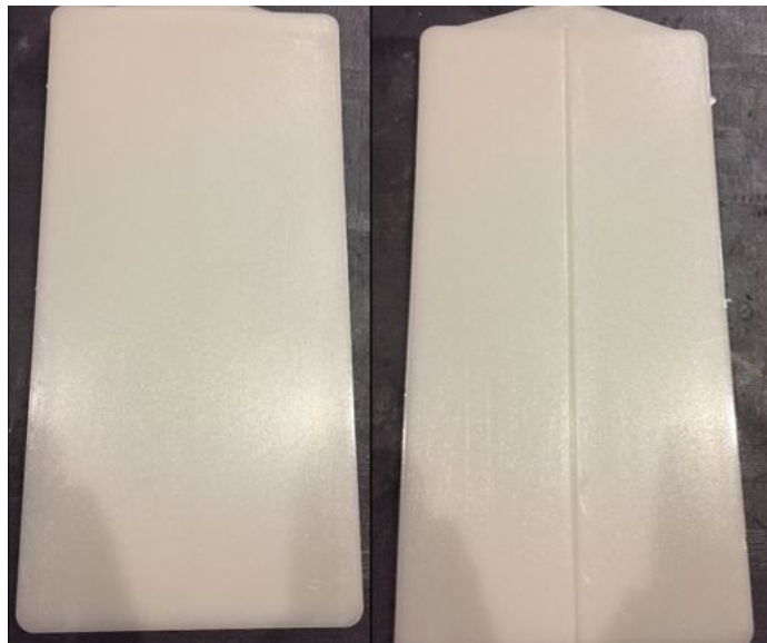
Figura 5.17: Probeta compósito HDPE-Compatibilizador con nanoarcilla I.31PS a 1 %más. sin defectos de inyección.
