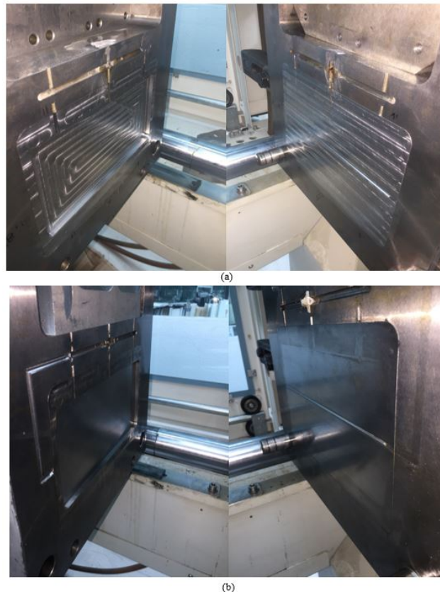
Figura 5.10: Molde montado en la máquina de inyección de plásticos Battenfeld TM 100/525; (a) antes de pulirlo y, (b) después de pulirlo
