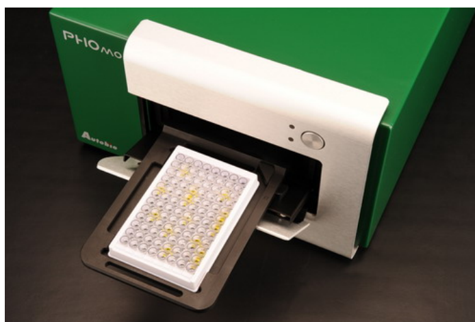
Figura 24 - Lector fotométrico de microplacas PHOmo Autobio, utilizado para el análisis del ensayo WST-8.
