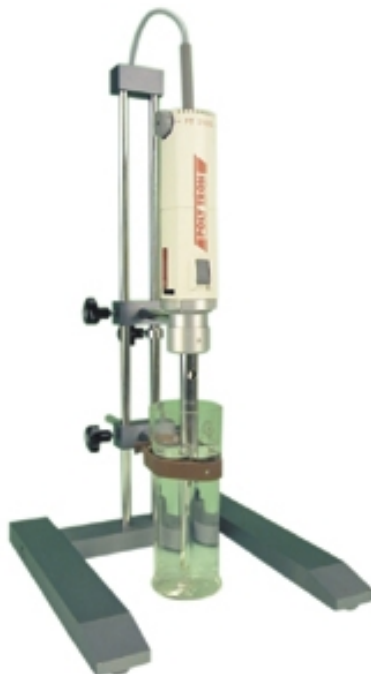
Figura 3 - Equipo Polytron PT-MR 2100 para homogenizar la emulsión de dos fases.
