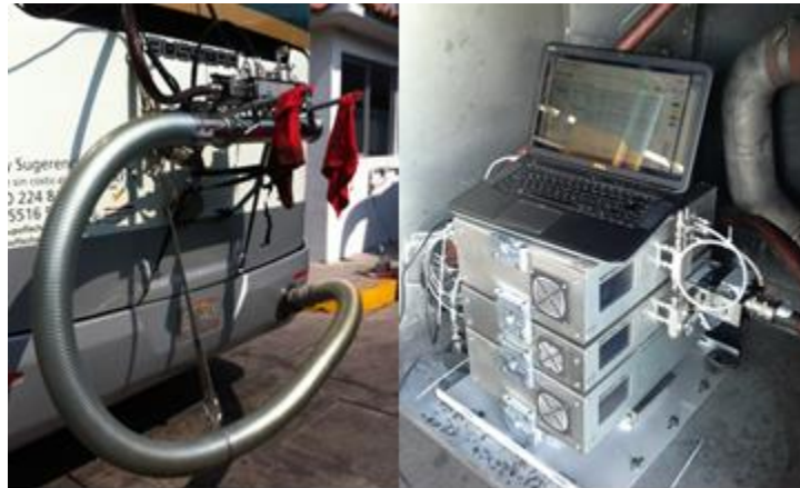
Figura 5-4 Equipo PEMS para medir las emisiones atmosféricas
