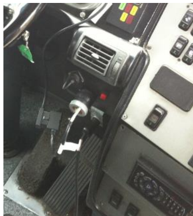
Figura 5-5 Toma para el conector J1939 que entrega los datos del motor
