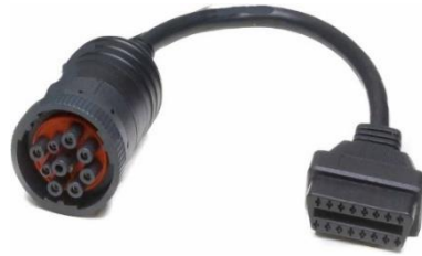
Figura 3-7 Conector J1939 utilizado en la toma de datos del consumo instantáneo de combustible
