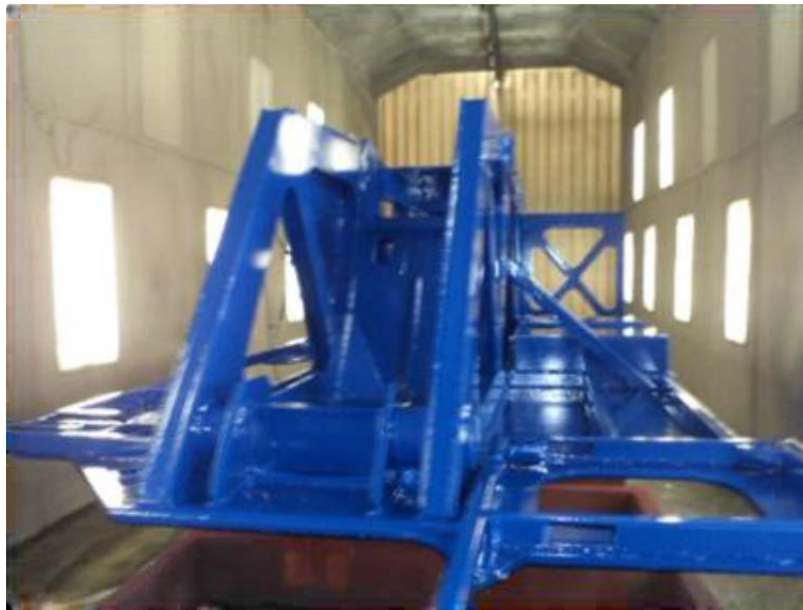
Figura 9. Chasis terminado en cabina de pintura
