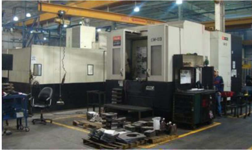
Figura 7. Centro de maquinado Horizontal
