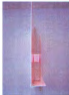
Figura 56. Vista lateral de la antena de cobre sin dieléctrico.
