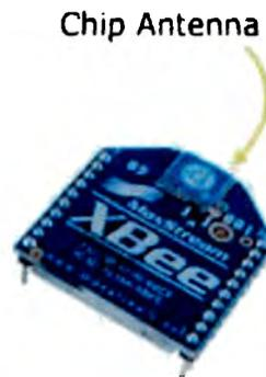
Figura 2.16: Antena de chip
