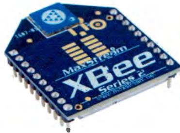
Figura 3.3: módulo Xbee
