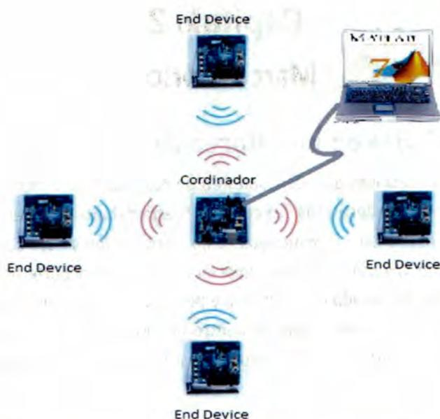
Figura 1.1. Topología de red para el monitoreo de una red fría de un hospital.
