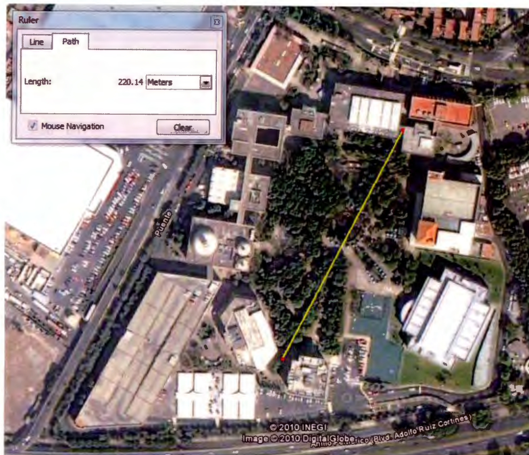
Figura 4.1 Alcance de Xbee® Pro con obstáculos.
