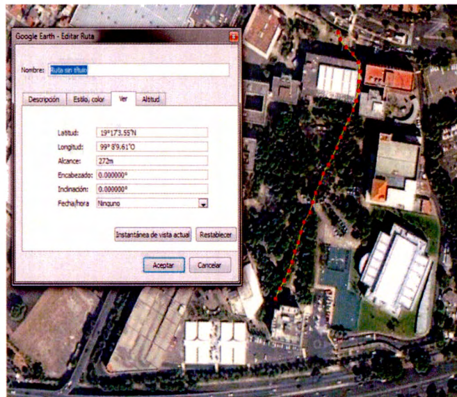
Figura 4.2 Alcance de Xbee® Pro y router con obstáculos.
