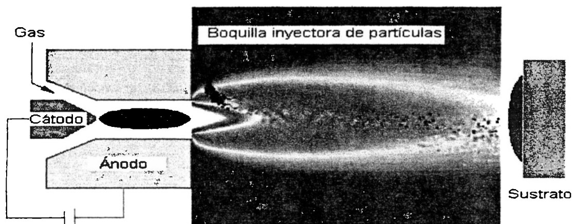
Fig. 3.11 Esquema térmico del jet de plasma
