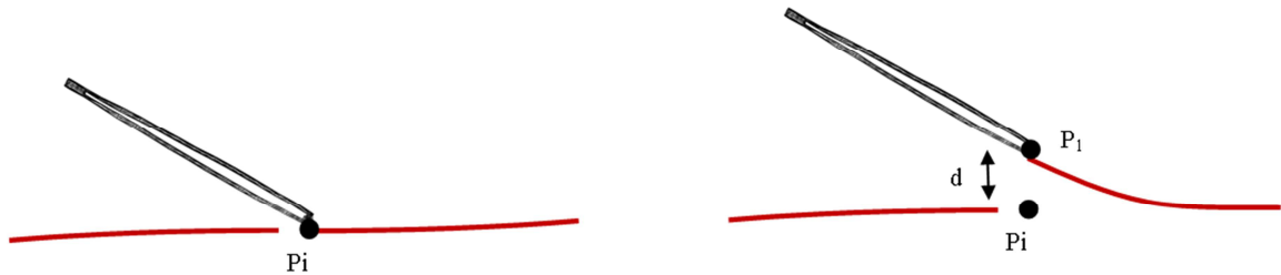
Figura 5.17 Cálculo de retroalimentación para la pinza de disección. P_i punto de contacto inicial, P_1 punto de contacto actual, d distancia entre P_i y P_1 .
