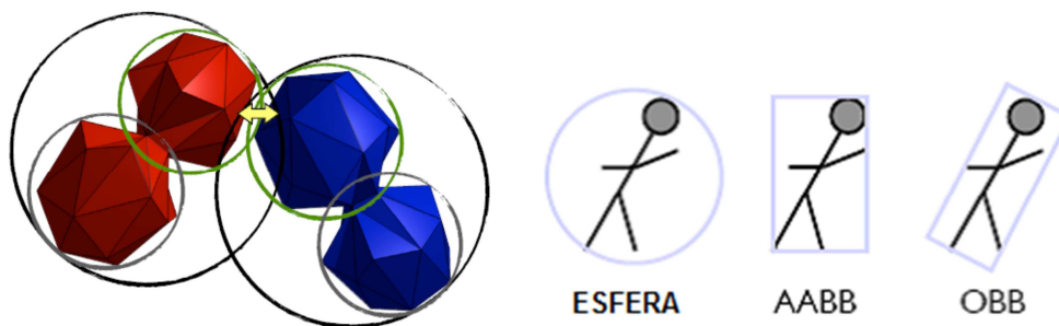
Figura 3.13 Técnica de colisiones mediante BVH (Salisbury, Barbagli, & Conti, 2010)
