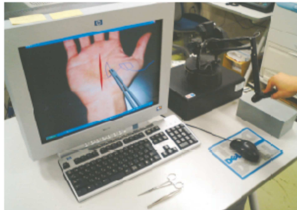
Figura 4.7 Apariencia del simulador de sutura (Miyazaki et al., 2006)
