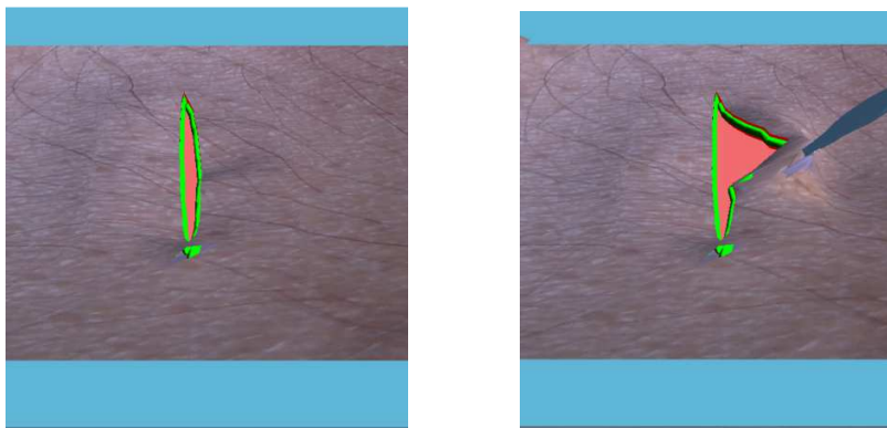
Figura 6.11 Cilindros auxiliares para detección de colisiones en la piel. a) Piel sin movimiento, b) Piel en movimiento
