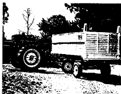
Para mejor maniobrabilidad la quinta rueda tiene un arco de giro de 360 grados
