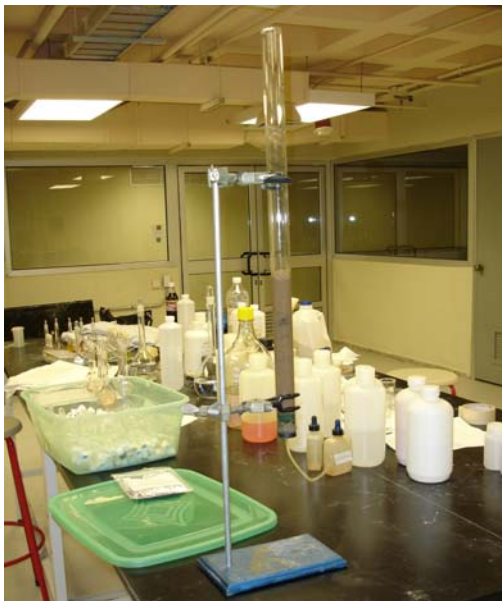
Gráfico No. 20 Filtro de arena sílica utilizado en la prueba
