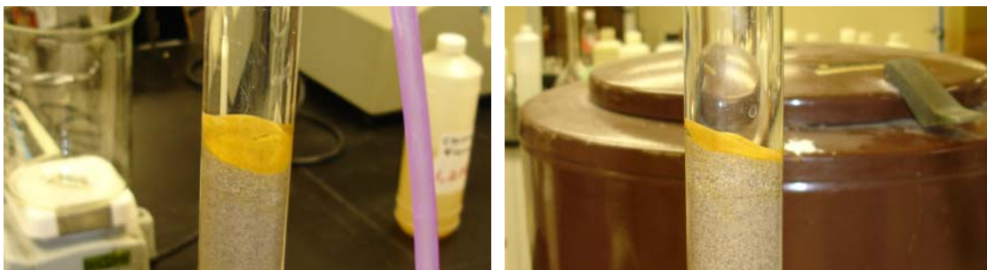
Gráfico No. 29 Capa rojiza sobre el lecho filtrante.
