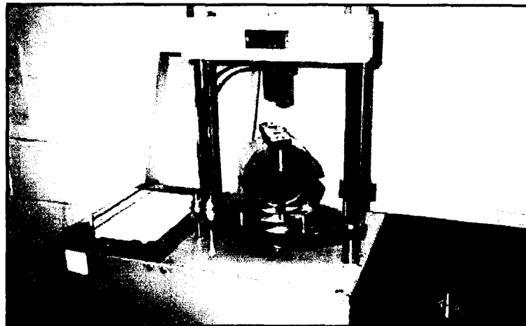
Figura 6.17: Aparato de Estabilidad para prueba de carga
