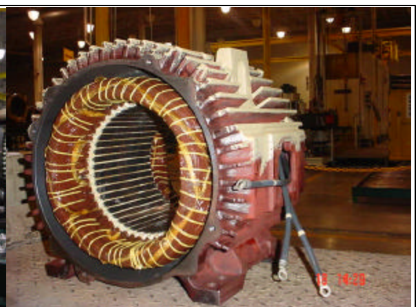
Figura 1.4 Estator ensamblado en el frame.
