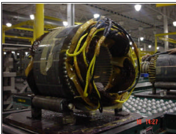
Figura 1.3 Estator con embobinado y cables conectados.
