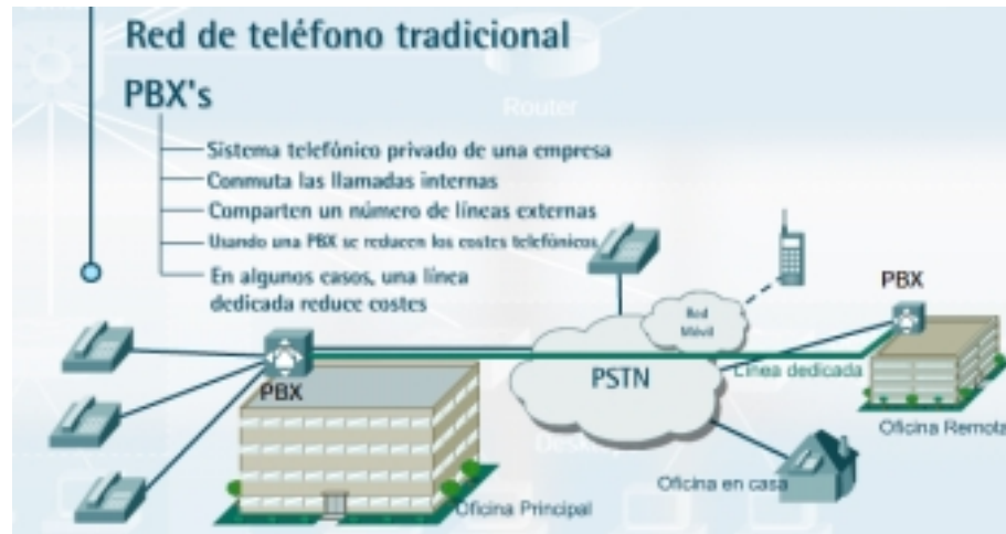
Figura 3. 1. Red telefónica tradicional en las empresas. Fuente: Cisco Systems 2003 b.
