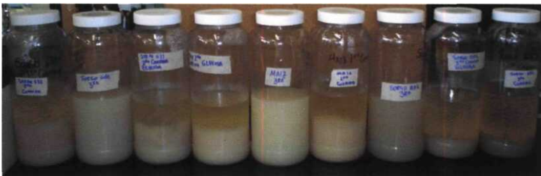
Figura 14. Jarabes después de la sacarificación: los tres primeros frascos son de sorgo normal, seguidos por tres de maíz y tres de sorgo ceroso. La nubosidad observada son dextrinas que no alcanzaron a ser hidrolizadas a glucosa
