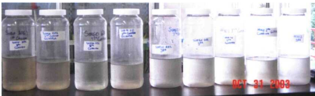
Figura 15. Jarabes glucosados refinados después de pasar por centrifugación, carbón activado, resina aniónica y resina catiónica.
