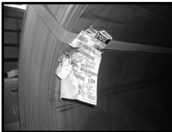
**Figura 4-5 Etiquetas de códigos de barras a veces están dañadas o mal colocadas.**
