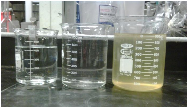
Figura 22. Agua gris y agua tratada con el sistema híbrido.
