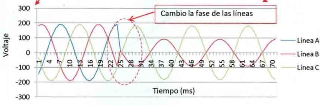
Figura 8. Cambio en la línea de las líneas que presentan fallas en el instante en que estas se presentan
